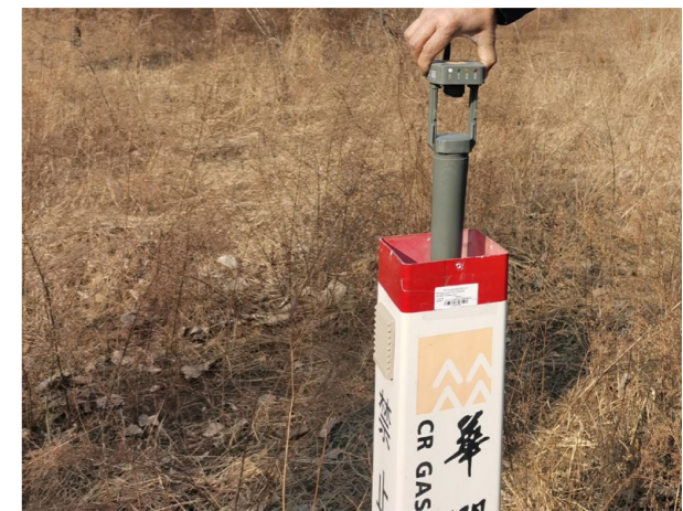
桩式地理“管网哨兵”可检测燃气泄漏和管网周围震动情况，有效提高燃气泄漏事故响应速度
